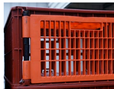
Exemple de réparation d'une porte
